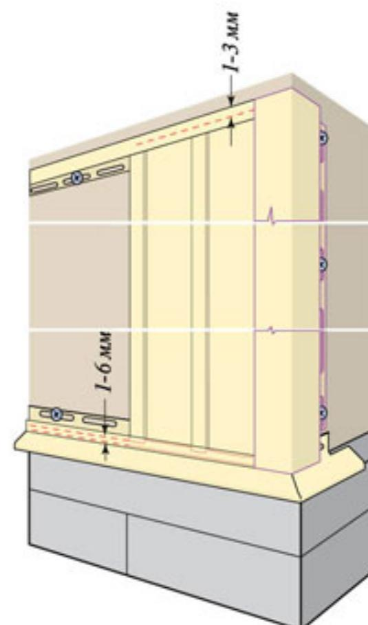
При монтаже вертикального сайдинга на цоколь дома вместо стартовой планки устанавливают отлив и/или окантовочный профиль, поверх устанавливается J-профиль, окантовочный профиль или молдинг. Крепится вертикальный сайдинг по аналогии с углами и Н-профилем.
