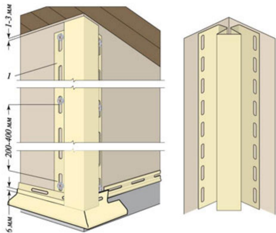
Внешние и внутренние углы устанавливаются на стыках стен так, чтобы их верхняя часть была на 1-3 мм ниже карниза или соффита, а нижняя часть на 4-6 мм ниже стартового профиля.
