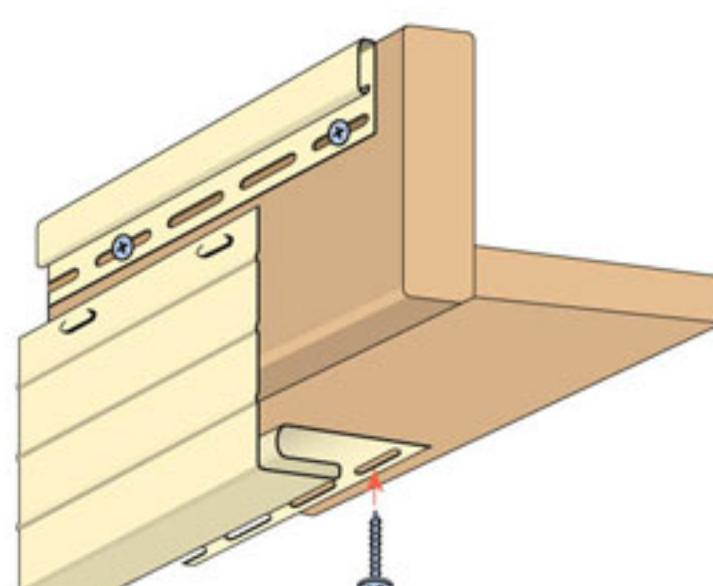
Горизонтальные J-фаски устанавливают по правилам крепления горизонтальных элементов, наклонные J-фаски крепят по правилам установки вертикальных элементов. К верхней кромке ветровой доски крепится финишный профиль. Фаска защелкивается в финишную планку на «зашепы». При необходимости удлинить J-фаску элементы закрепляются внахлест на величину 25 мм.
